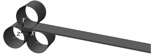
图 5 三辊滚弯成形的有限元模型
