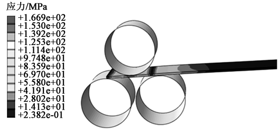
图9 接触阶段的应力分布
