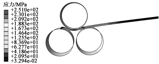
图10 预弯结束阶段的应力分布
