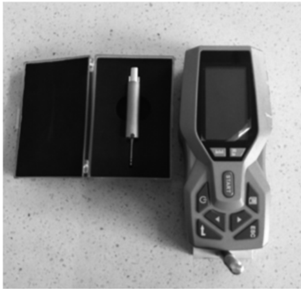
图 3 表面粗糙度仪 Fig. 3 Surface roughness meter
