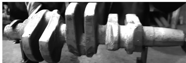
图 14 42CrMo 钢三缸曲轴终锻件
