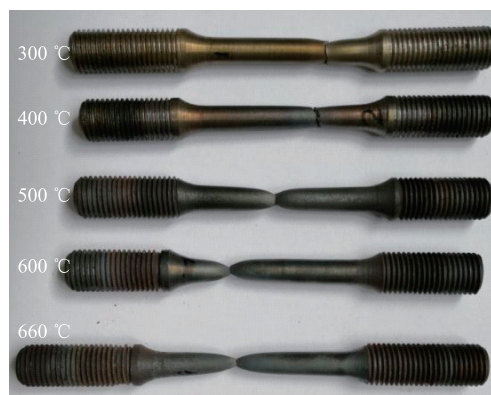
图 6 新延长拉杆的高温拉伸试样图片
