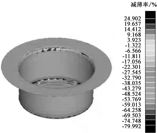
图 8 最优方案减薄率分布图 Fig. 8 Distribution diagram of thinning rate for optimal scheme
