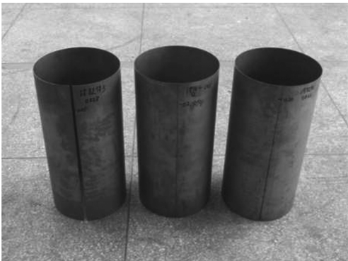
图 5 两轴柔性滚弯试验件 Fig. 5 Test parts of two-axe flexible roll bending
