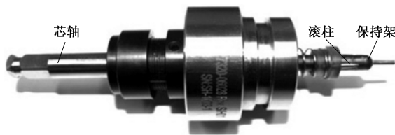
图2 旋压连接装置
