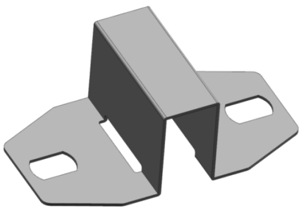
图2 锁定臂三维零件图
