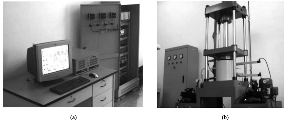
图8 胀形实验装置
