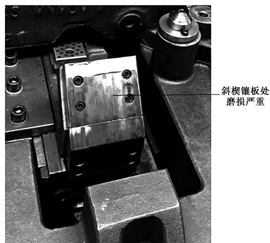
图2 现场插刀处斜楔镶板的磨损图片
