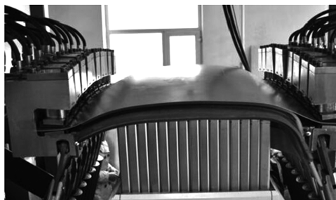
图 7 柔性拉伸成形装置
