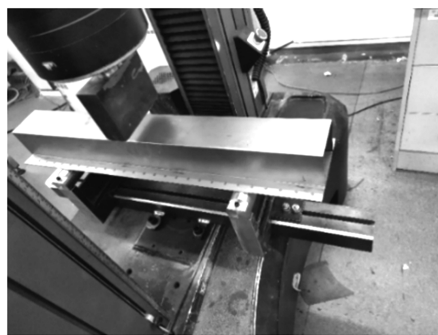
图 13 帽形梁准静态三点弯曲试验装置
