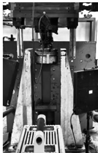
图 16 帽形梁动态轴向压溃试验
