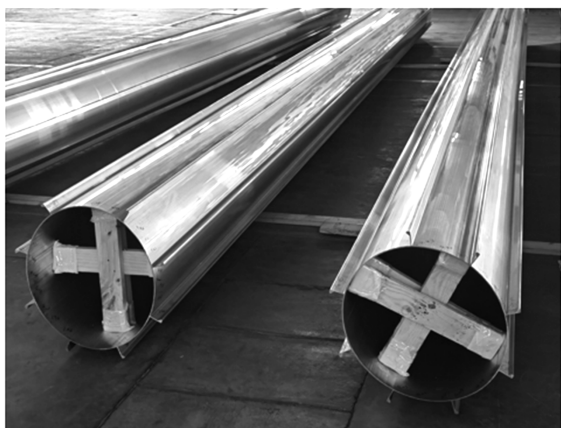
图10 大型带筋薄壁圆管铝型材
