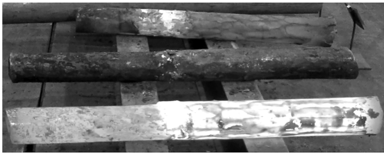
图 3 终锻后直径为 \Phi 110 mm 的坯料 Fig. 3 Blank with diameter of \Phi 110 mm after final forging
