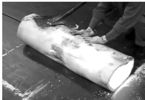
图 1 电渣锭保温后包裹石棉
