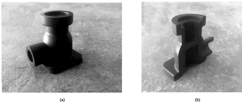
图 8 安全阀阀体锻件试验结果
