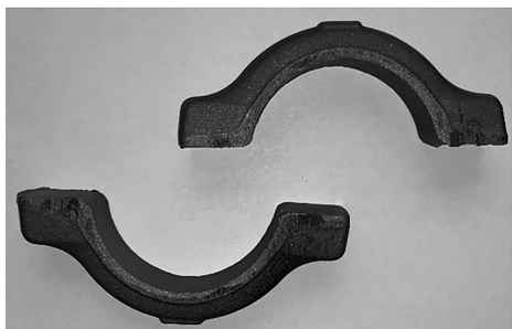
图 10 卡箍热模锻造成形锻件
