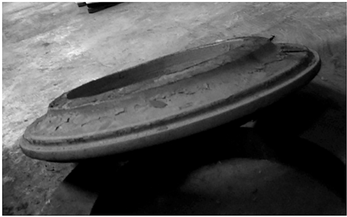
图 20 实际锻造成形的滚刀刀圈 Fig. 20 Actual forged hob ring
