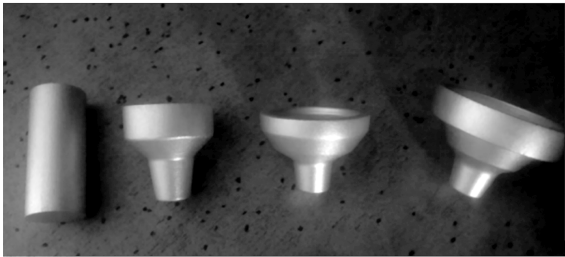
图 6 法兰盘体各工序锻件
