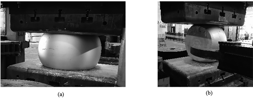
图 15 开坯锻造过程 (a) 墩粗 (b) 拔长 Fig. 15 Blank forging process (a) Upsetting (b) Drawing
