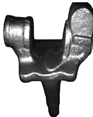
图 8 最优参数组合下的转向节锻件
