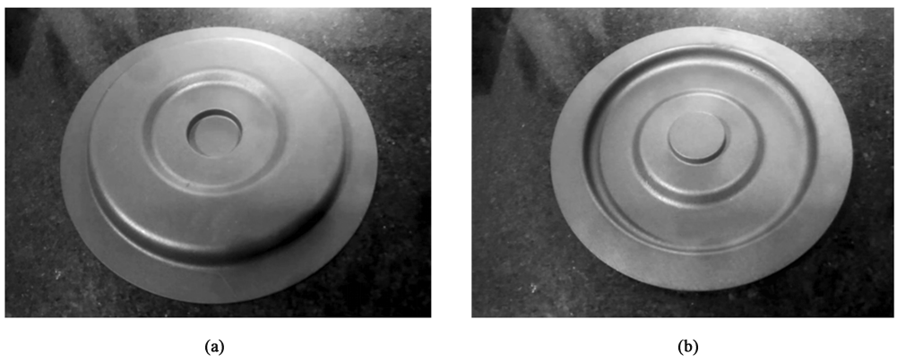
图 4 DP780 高强钢板制件 (a) 正面 (b) 反面 Fig. 4 DP780 high strength steel plate part (a) Positive (b) Negative
