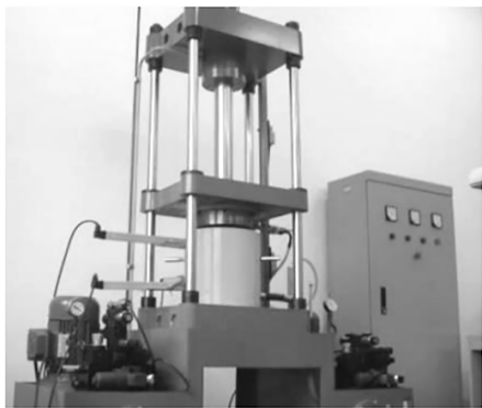
图 8 外高压胀形实验设备
