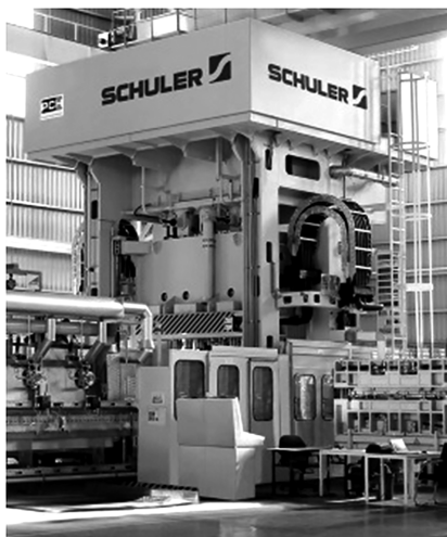
图2 德国舒勒公司热冲压生产线中的 PAL400 热成形压机 Fig. 2 Hot forming press PAL400 in hot stamping production line of Schuler company in Germany
