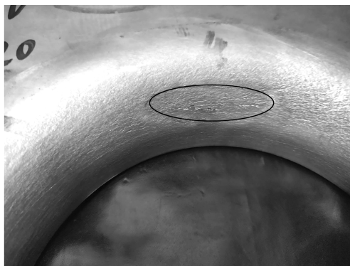
图11 凹模圆角处裂纹
