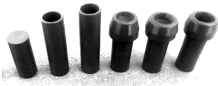
图 11 哈克钉铆套各工位零件成形图
