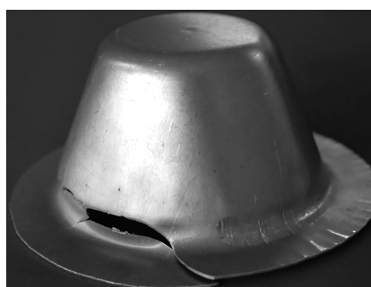
图 8 锥面与直壁过渡区的破裂缺陷
