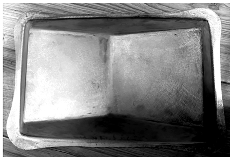
图 13 簸箕形薄壁件成对拉深成形实物图
