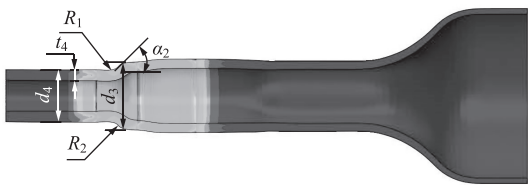
图 10 第 1 次挤压成形后的管坯 Fig. 10 Tube blank after the first extrusion forming
