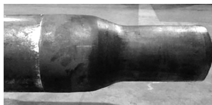
图 21 端缩后的轴头部分
