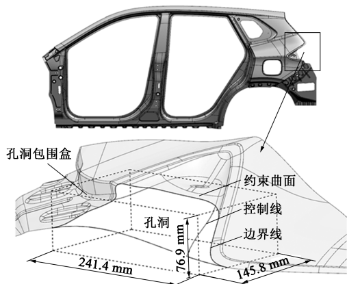
图 10 汽车侧围外边界上的孔洞
