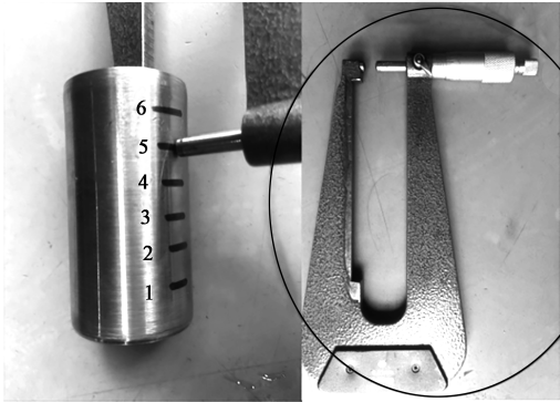
图 3 变薄拉深工件壁厚测量
