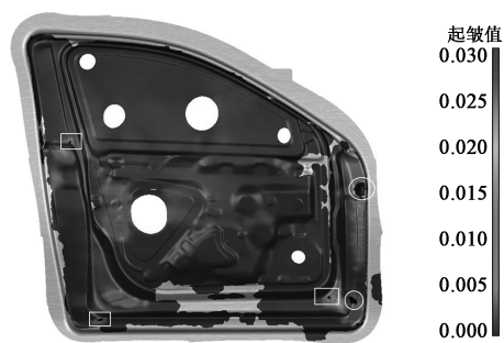
图7 1#门内板 Sigma 模式下的起皱值分布
