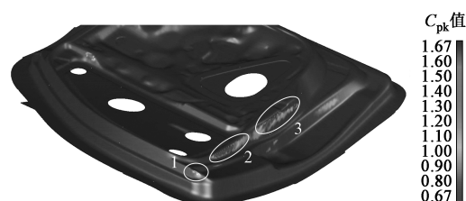
图9 1# 门内板 Sigma 模式的 C_{pk} 分析结果 (连续)
