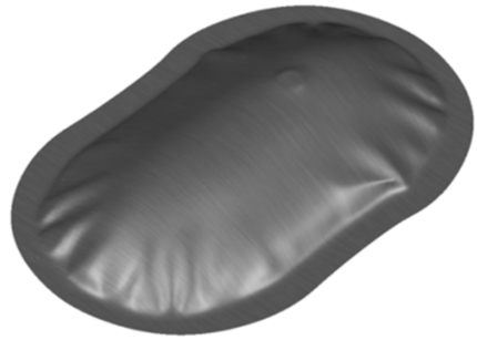
图 2 起皱的零件 Fig. 2 Wrinkled part
