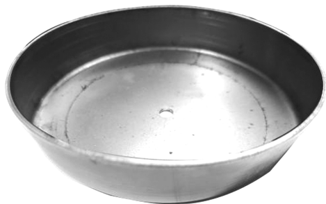
图15 旋压实验零件图
