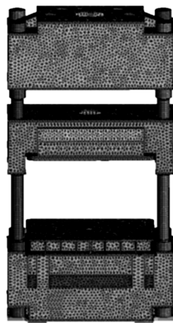
图 2 液压机的有限元模型
