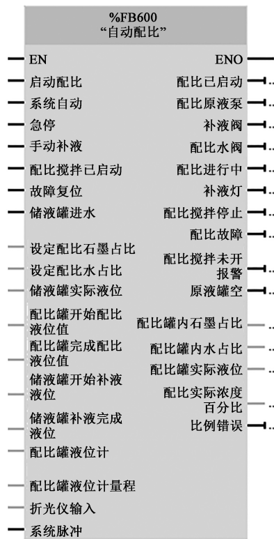
图 8 自动配比功能块 Fig. 8 Automatic matching function blocks
