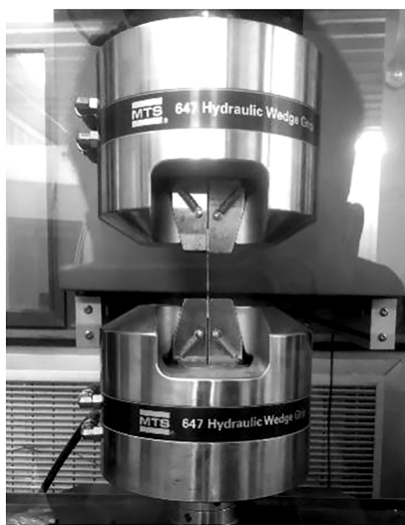
图 4 单轴拉伸实验
