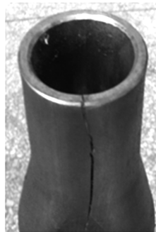
图10 端部开裂管件
