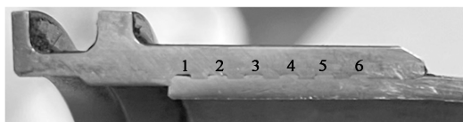
图 14 管端滚压连接后剖切检查部位
