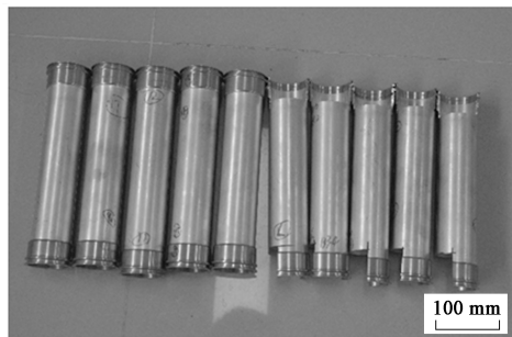
图 17 LF2M-G75×1.5 铝合金管材管端滚压连接试验件 Fig. 17 Rolling connection test parts of pipe end for LF2M-G75×1.5 aluminum alloy pipe
