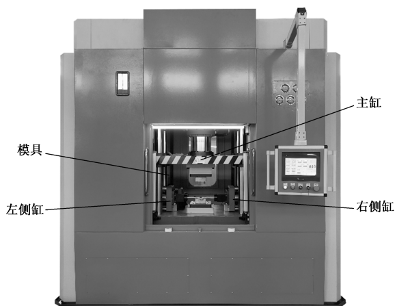
图 3 思豪 HF-100T 伺服水胀压力机
