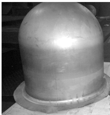
图 11 充液成形球底筒形件构件
