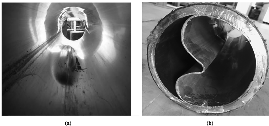
图 1 双金属衬里复合管内衬塌陷的形貌
