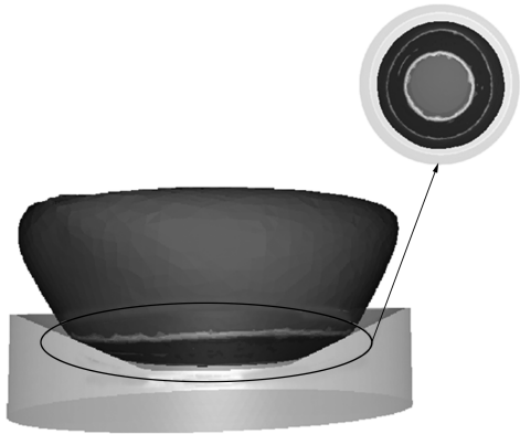
图 10 预成形锥面接触面积 Fig. 10 Contact area of preformed cone
