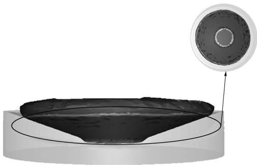
图 11 终锻充型锥面接触面积 Fig. 11 Contact area of final forging cone
