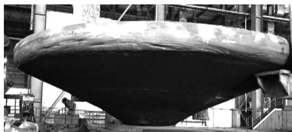
图 22 \Phi 6.5\ \text{m} 砗铁锻件
