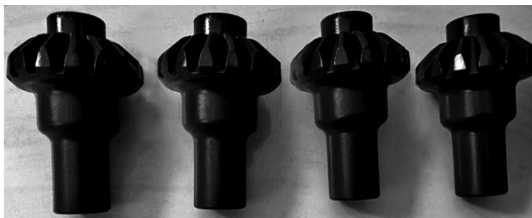
图 9 试制得到的空心齿轮轴锻件
