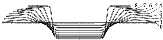
图 5 汽车门槛件辊花图
