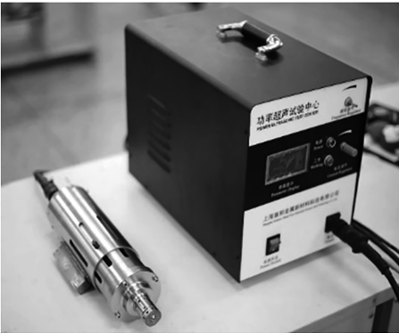
图 3 超声加工执行装置 Fig. 3 Ultrasonic machining actuator
