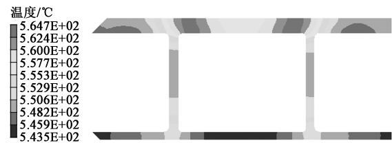
图 5 型材截面温度分布云图
