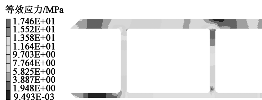
图 10 第 1 次优化后型材截面等效应力分布云图
