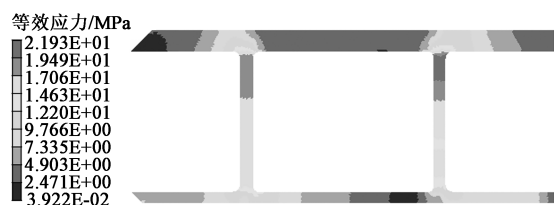
图 6 型材截面等效应力分布云图
