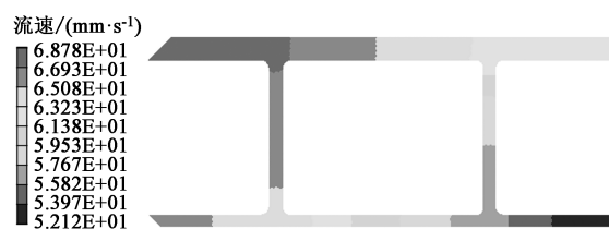
图 8 第 1 次优化后型材截面流速分布云图
