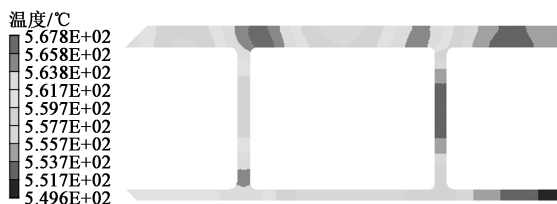
图 9 第 1 次优化后型材截面温度分布云图
