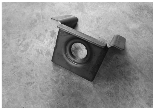
图9 汽车加强板冲压产品实物图
