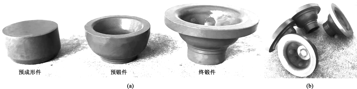
图 12 法兰盘零件锻造试验结果
