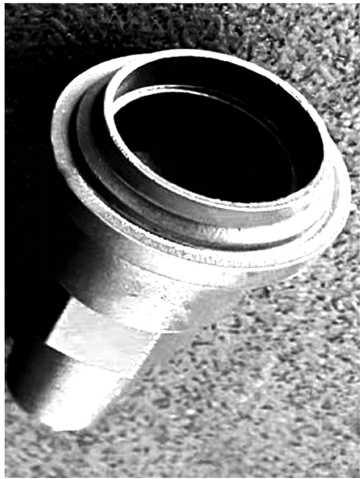
图 12 传动轴轴套 Fig. 12 Transmission shaft bushing
