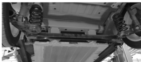
图 21 某电动出租车搭载扭力梁实车路试
