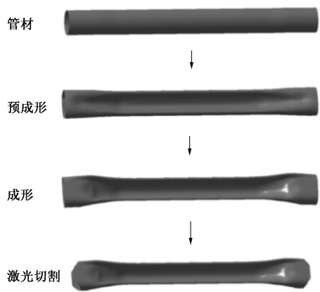
图 9 管梁成形工艺
